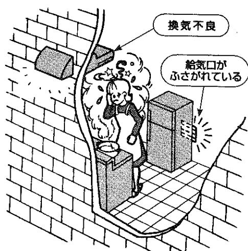
曲げられていることが多いため、年数が経つにつれて、ホコリの付着が顕著になり排気効率も落ちます。何らかの原因でダクトの接合部がはずれたり、固定部材から脱落していた例もあります。また、排気出口部分の防鳥網が錆びてボロボロになり、そこから鳥が入り込んで巣を作っていたため死亡事故につながった事例もあります。
